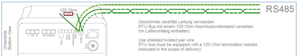
An der AC ELWA 2 ist der Anschluss durch RS485, A, B, GND gekennzeichnet.
