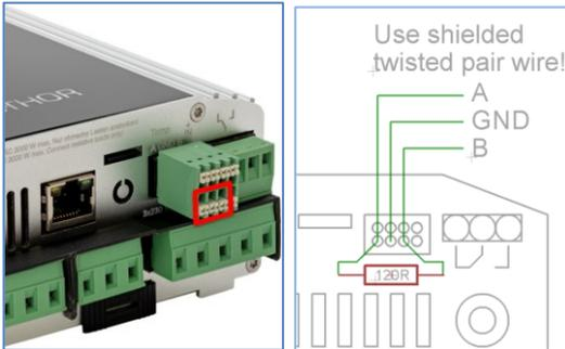
Drei Pins am 8-poligen Stecker des AC•THOR sind der Modbus RTU Kommunikationsanschluss. Beim AC•THOR ist der 120 Ohm Abschlusswiderstand nicht im Lieferumfang enthalten!
