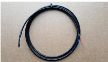
Wenn der Fühler (siehe Abbildung) einen Messwert >80 °C anzeigt, sind die Kontakte möglicherweise nicht korrekt angeschlossen, oder es liegt unter Umständen ein Fühlerbruch vor. Ein negativer Wert kann ein Hinweis auf einen Kurzschluss sein.
