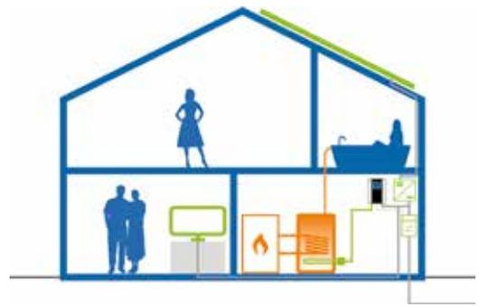
Chauffage de l'eau à l'aide de l'installation photovoltaïque jusqu'à 9 kW.
