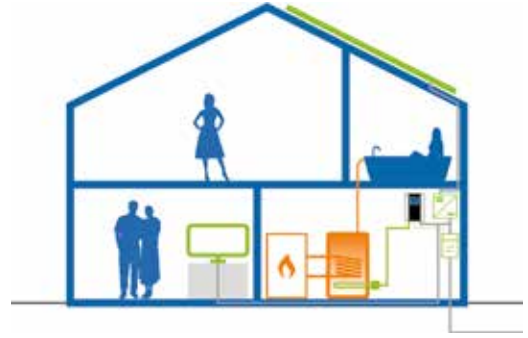
Sade fotovoltaik ile su ısıtma 9kW
