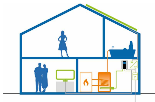
PV warmwatervoorziening tot 9 kW.
